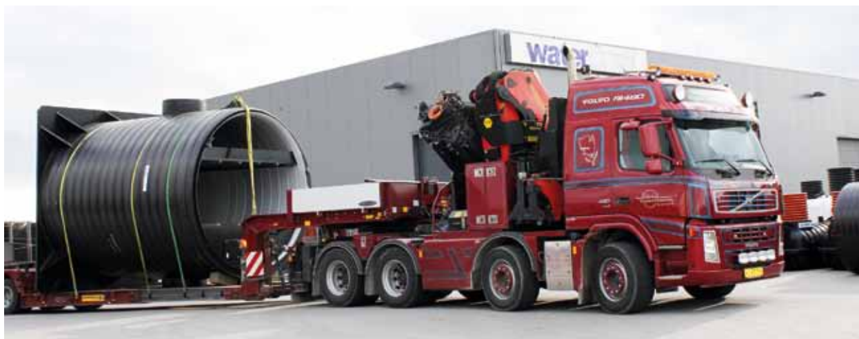
Lameludskiller 80/160/1600 l/s på vej fra Watercare til Selsmosen.
